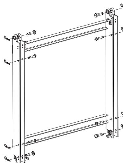
Les vis M8 x 20 mm sont destinées à solidariser entre eux les montants verticaux et les profilés transversaux, de façon à constituer un cadre de suspension.
